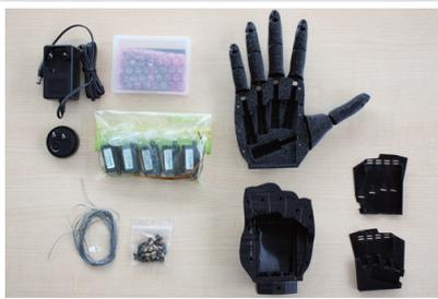
5自由度の多関節ロボットハンドの組み立てキット。指を動かすためのアクチュエータや制御のための小型ボード(ATMEGA2560搭載)等がセットになっており、Arduino開発環境を用いてプログラミングが可能です。
