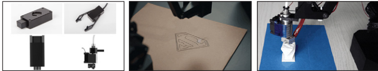
取替可能なエンドエフェクタ レーザー刻印 (Pro版機能) 3Dプリント (Pro版機能)
