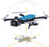
運動を司る3軸の角度と加速度を検出するための装置。運動体に搭載した際に、その機体の姿勢に関するデータの検知・取得が可能となります。
